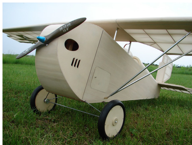
Szczegóły sztywnego układu podwozia i zastrzał w modelu o rozpiętości 2,2 m
