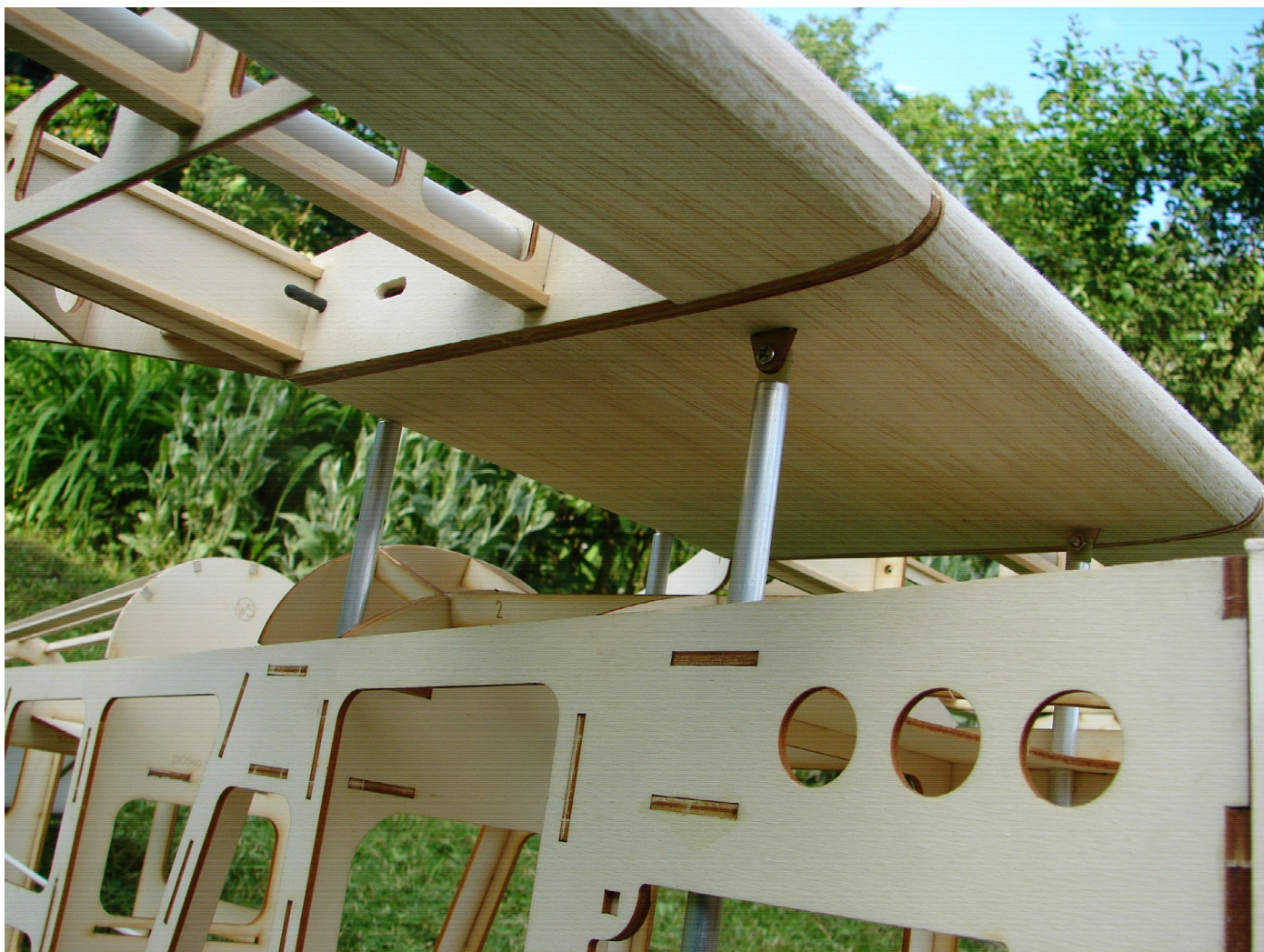
Zamocowanie płata do kadłuba w obydwu wersjach modeli DKD-I wzorowane jest na rozwiązaniach oryginału – zastosowano cztery rurki. Na zdjęciu: model o rozpiętości 2,2 m.
