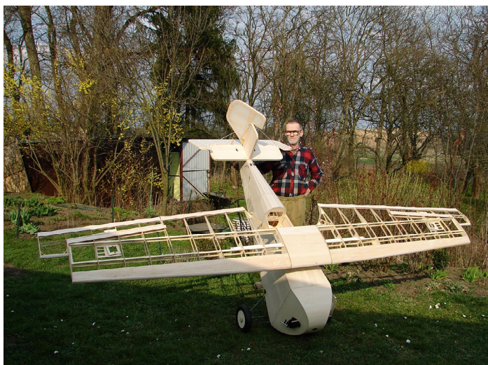
Leszek Jura – autor projektów i twórca zestawów modeli DKD-I z modelem o rozpiętości 3,7 m. Model na etapie nakładania pokrycia...
