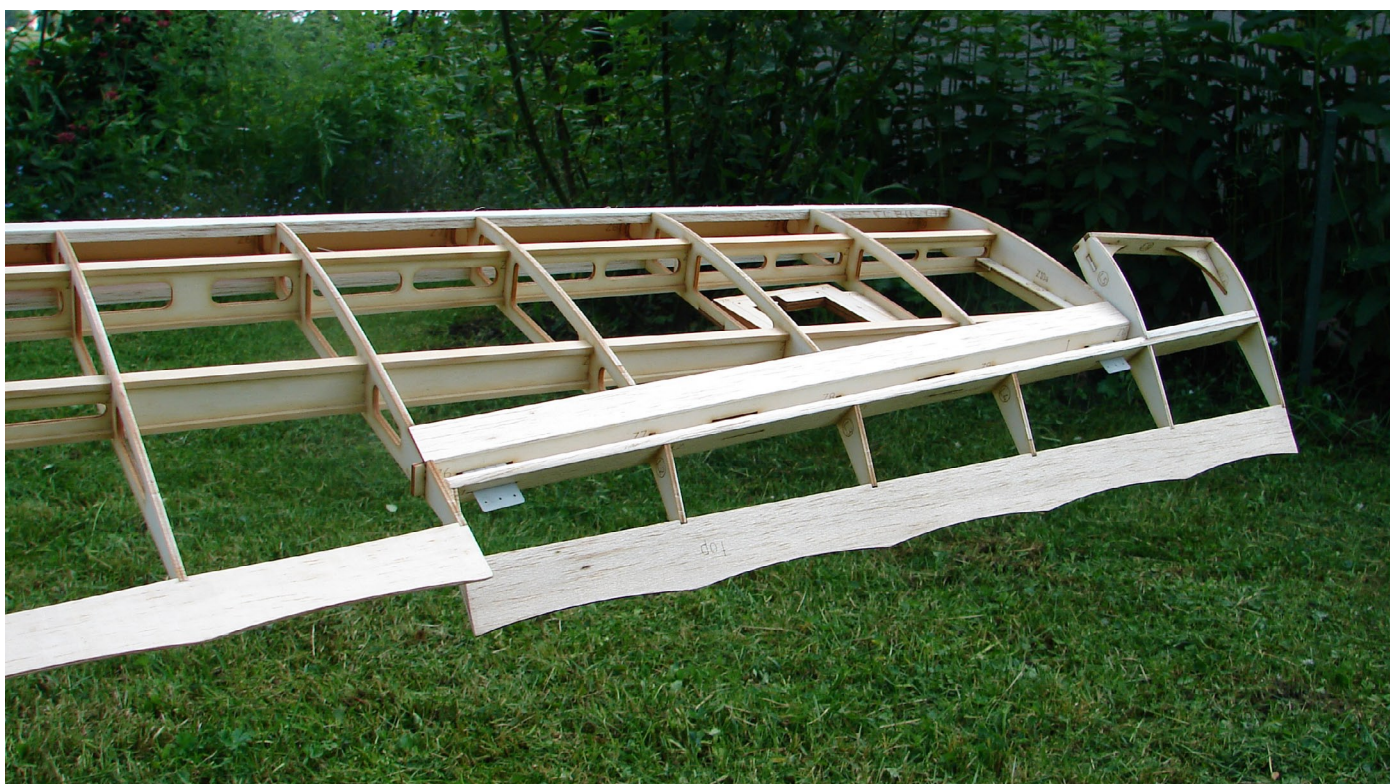
Szczegóły konstrukcji fragmentu prawego skrzydła wraz z lotką w mniejszym modelu. Dobrze widoczna jest też konstrukcja dźwigarów.
